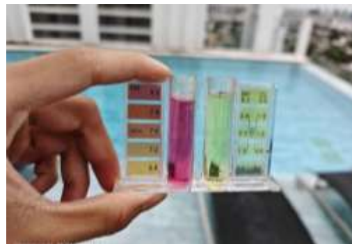
รูปที่ 20 ตรวจวัดค่า pH สระว่ายน้ำ
